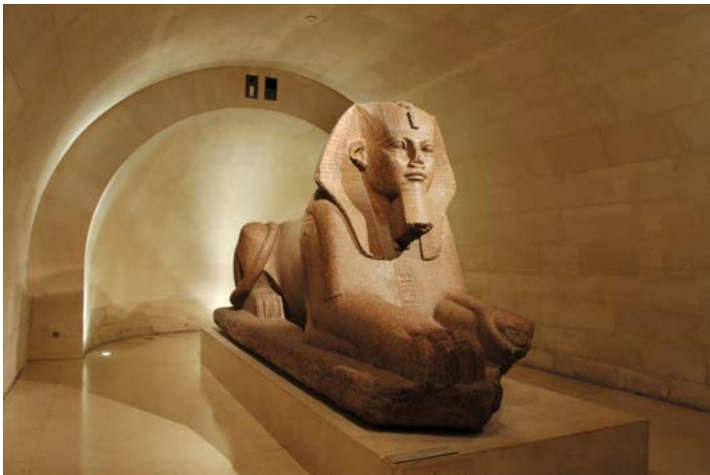
Louvre: Iluminat indirect al sfinxului pentru a evita reflexiile de pe suprafața pietrei
