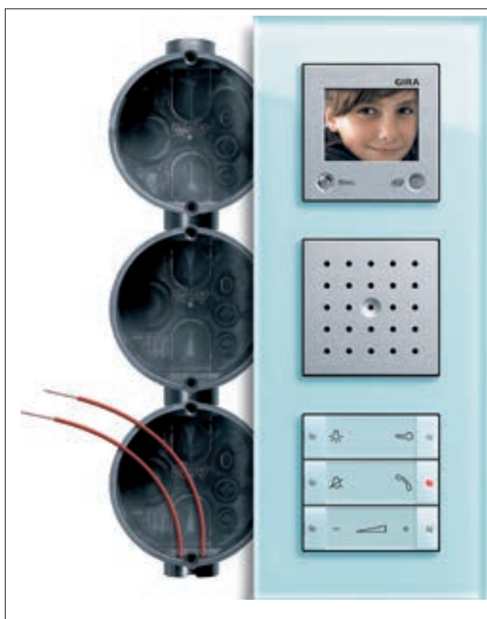
Sistemele de interfonie Gira folosesc tehnologia de transmitere a informațiilor, de tip "bus", prin intermediul a două fire și se montează în doze uzuale pentru aparate electrice
