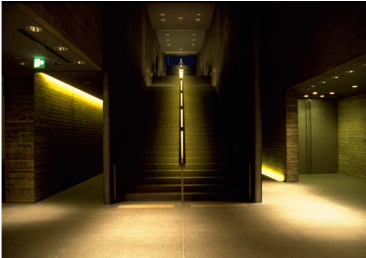
S-au folosit downlight-uri fără orbire și s-au făcut toate eforturile pentru eliminarea orbirii din câmpul vizual.
